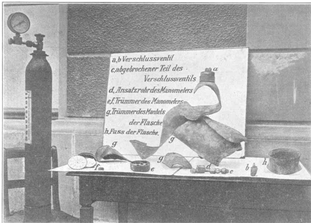
Abb. 1. Trümmer der explodierten Flasche und des Probiermanometers.
